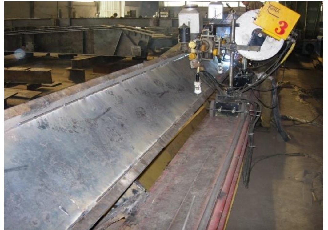
جوشکاری با استفاده از سیستم زیر پودری
