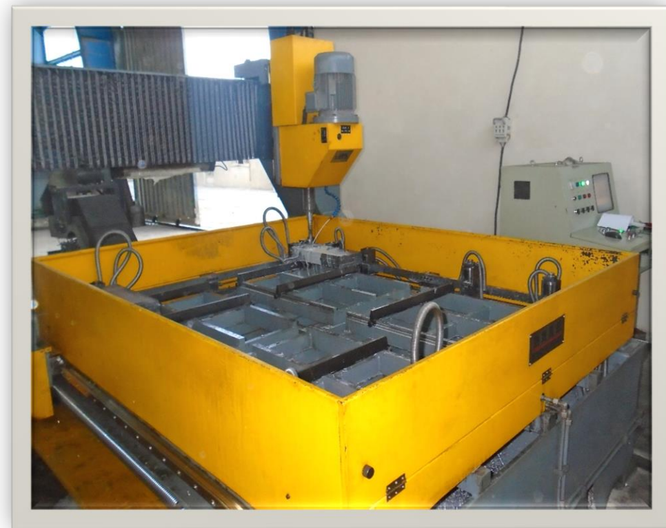
استفاده از دریل پلیت سی ان سی جهت سوراخکاری ورق ها
