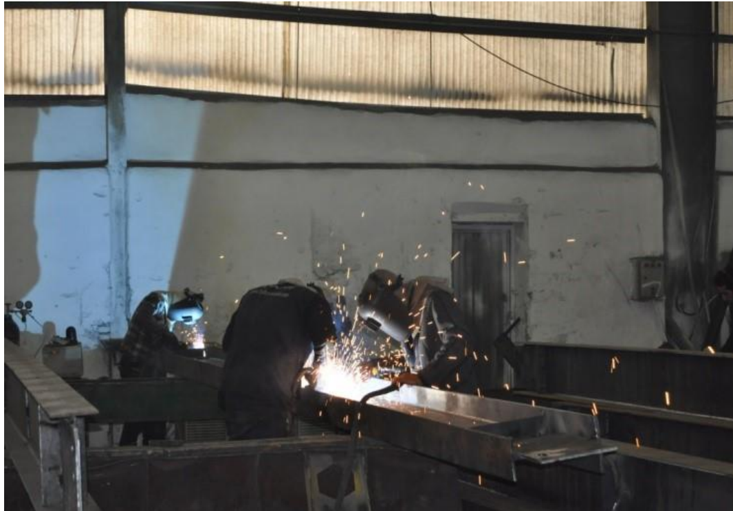
جوشکاری با استفاده از سیستم میکس مگ
