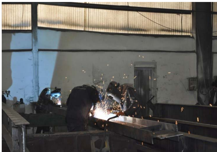
جوشکاری با استفاده از سیستم میگ مگ
