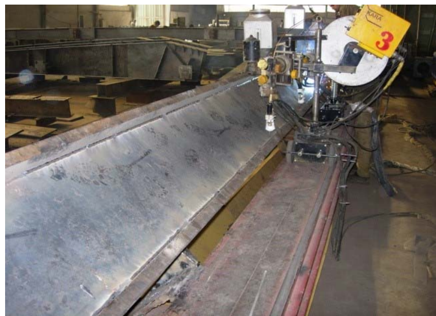
جوشکاری با استفاده از سیستم زیر پودری
